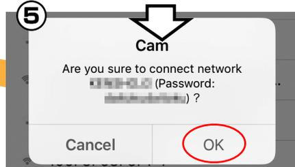
5 「OK」をタップ。数分かけてカメラが再起動します。スマホの Wi-Fi 接続先は自動的に無線 LAN ルーターに設定されます。
